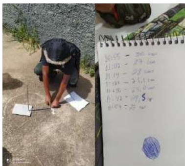
Fig. 11: Alunos do ensino médio realizando o experimento do Gnômon e tabelando as medidas em seus cadernos.
