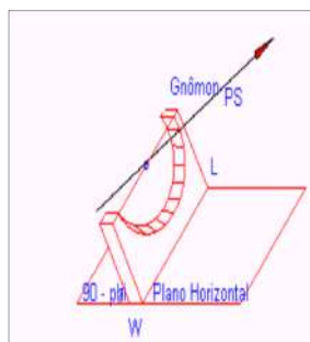
Fig. 90: Modelo de Relógio de Sol com montagem equatorial
