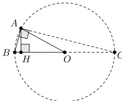
Traçando o diâmetro  $BC$  e a corda  $AC$  da figura, o triângulo  $ABC$  será retângulo em  $A$ , pois o ângulo  $B\hat{A}C$  determina um arco de  $180^\circ$ .
